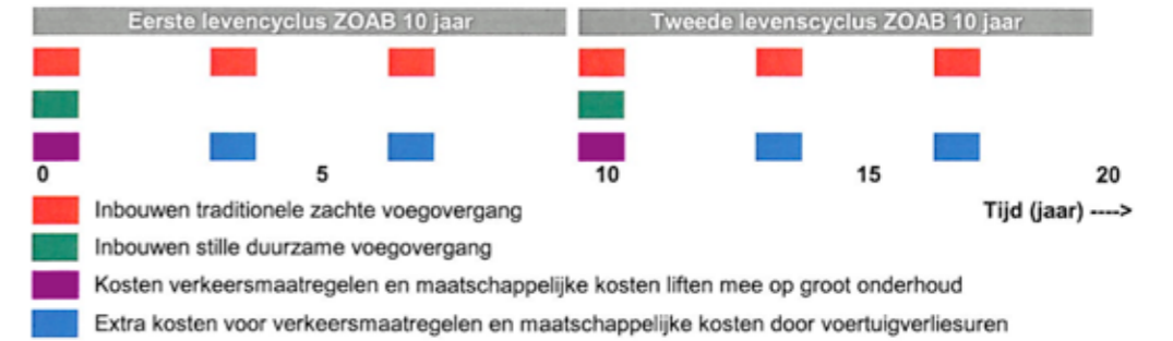
Afbeelding 56: Gelijk maken van de onderhoudscyclus voegovergangen en wegdek
