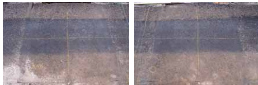
Afbeelding 31: De BrainJoint na 89.000 lastherhalingen. Links: de +13 mm voegovergang. Rechts: de -13 mm voegovergang
