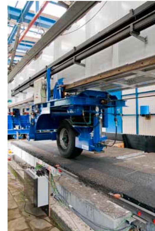
Afbeelding 28: De belastingswagen over een ingebouwde voegovergang
