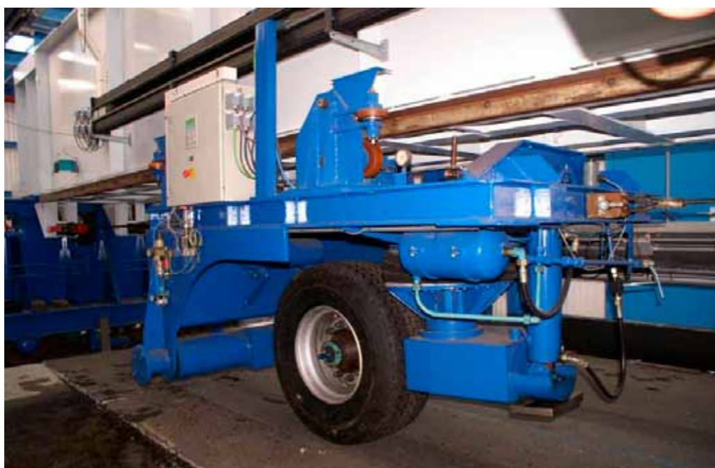
Afbeelding 22: Belastingswagen met vrachtwagenwiel en supersingle band
