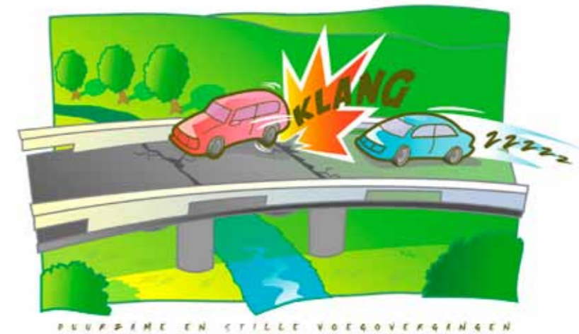
Afbeelding 4: Hoe stiller het wegdek hoe hinderlijker het impulsgeluid van voegovergangen
