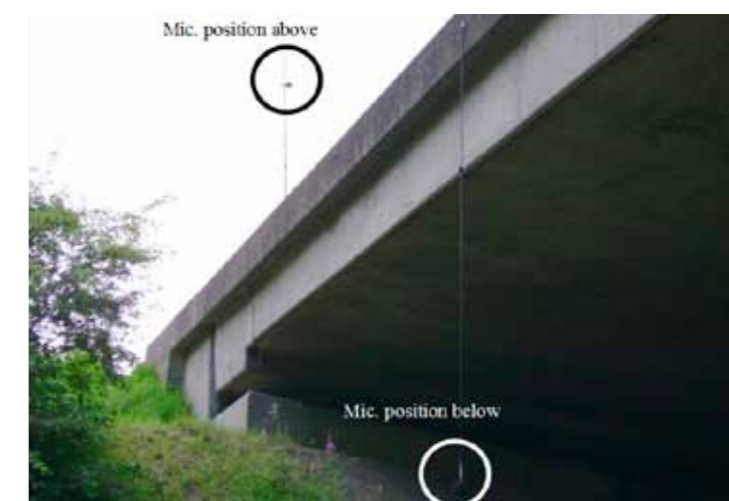
Afbeelding 46: Meetopstelling microfoons bij de SPB methode
