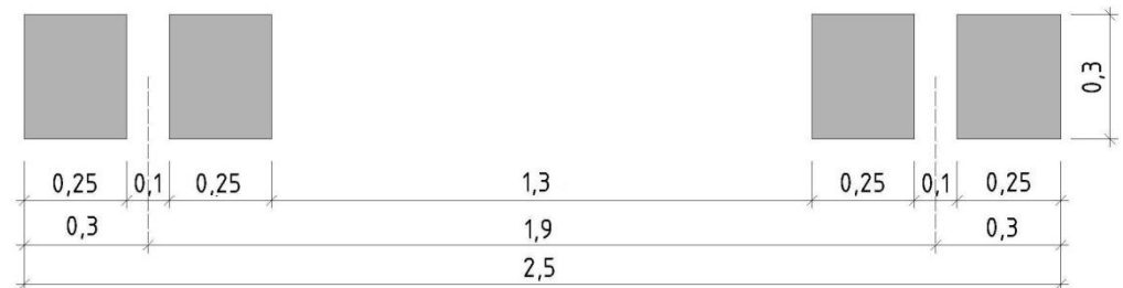
Figuur B1.3: wielcontactoppervlakken
