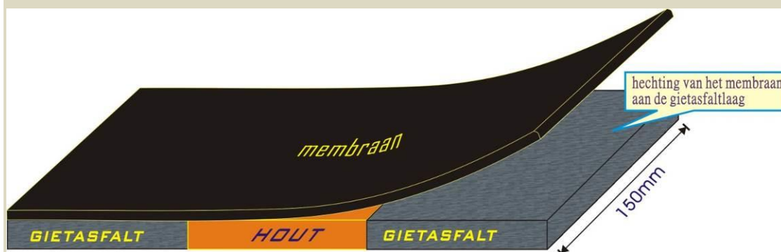
B7.10 Membraan-installatie op de bovenkant van GA
