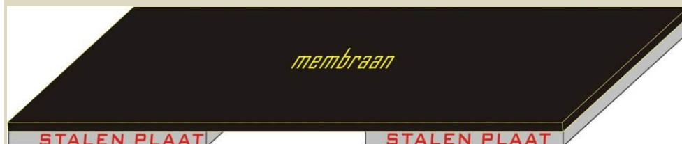
Figuur B7.5 Schematische weergave van het uiteindelijke staal membraan proefstuk
