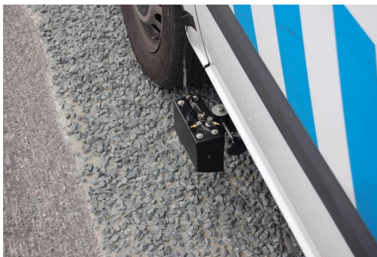
figuur 9 De laser-hoogtemeter, gebruikt voor de hoogteprofielmetingen
