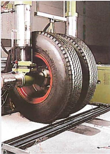
Überrollversuch an der TU München Prüfstand
