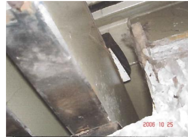
Fixatie druklagers beschadigd. Drukveer 'aan de wandel'
