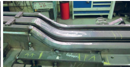
Situatie zonder stootlassen, beperkte kans op lekkage
