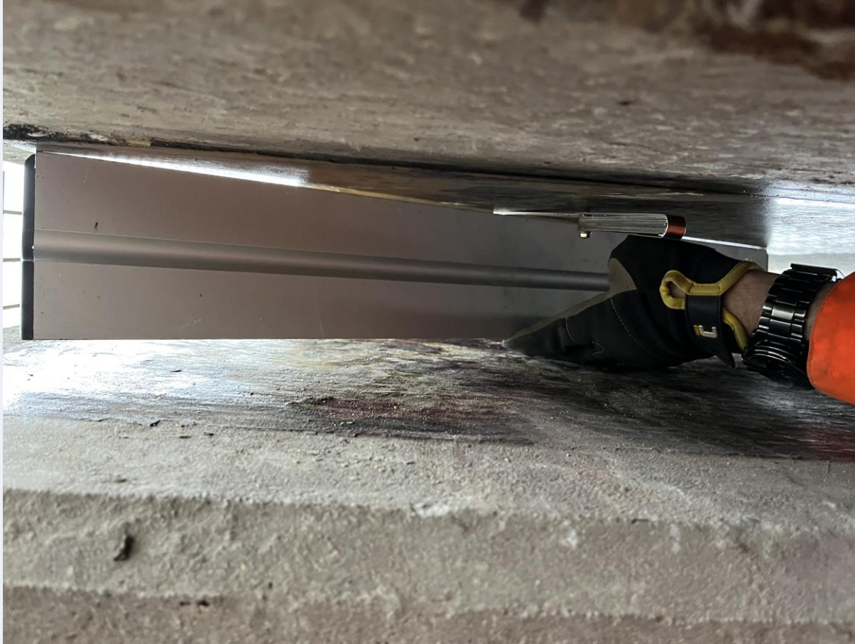
Onvlakheid contactvlak bovenbouw
